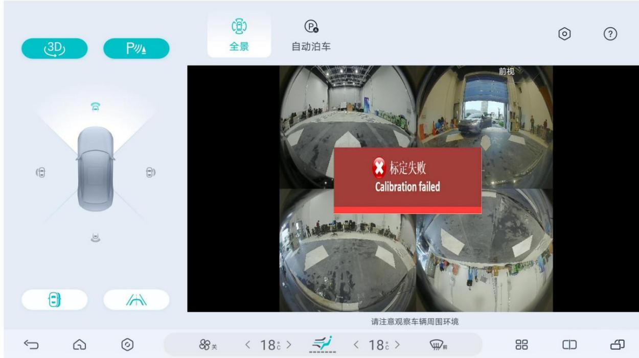
Si la calibración falla, revise el entorno del vehículo, compruebe que el paño de calibración esté extendido, confirme que las cuatro puertas y las dos tapas estén cerradas, presione los botones de plegado y desplegado del espejo retrovisor y vuelva a calibrar según los pasos anteriores. Si la calibración sigue sin funcionar después de repetirla dos veces, apague y reinicie el sistema y vuelva a calibrar.
