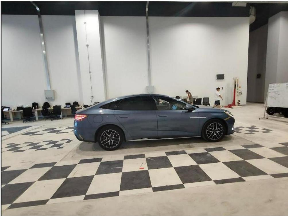
Durante la medición específica, para garantizar que el eje central del vehículo esté ubicado en la línea central del paño de calibración, la distancia desde el lado exterior de los cuatro neumáticos hasta el lado interior del paño de calibración es igual a 35 cm, como se muestra en la figura siguiente.
