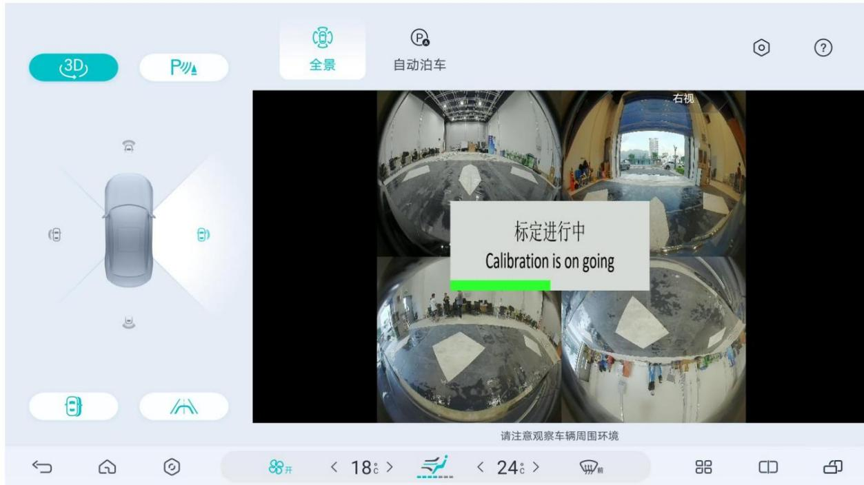
7. Espere unos segundos. Si se muestra la siguiente imagen, significa que el sistema de imágenes panorámicas se ha calibrado correctamente.
