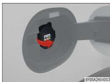
5. Presione el botón negro en el enchufe de carga, conecte el enchufe de carga en la toma de corriente del vehículo hasta el final y luego suelte el botón negro.
