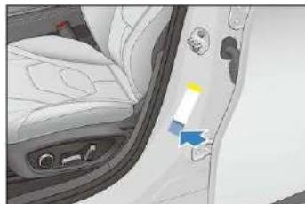
La etiqueta de advertencia de carga de CA se pega en la parte interior de la puerta del puerto de carga de CA.
