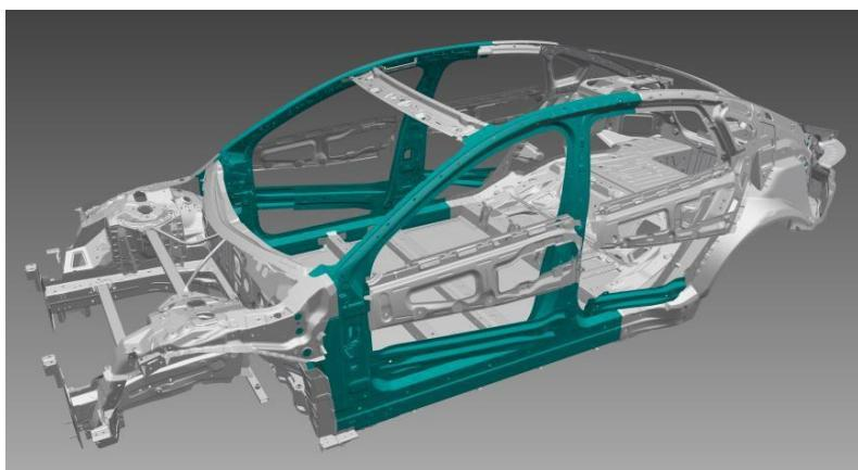
Los pilares B de este vehículo están fabricados con acero de resistencia. Las puertas del vehículo están hechas de acero galvanizado. Todos los demás componentes estructurales del cuerpo están hechos de varias resistencias de acero.
