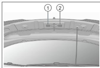
La etiqueta de advertencia de la bolsa de aire de seguridad lateral se pega en la parte inferior del anillo de cerradura de la columna B izquierda / derecha.
